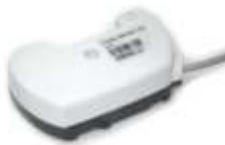
Der CYBLE Sensor ist ein für den Außeneinsatz optimierter, wasserdichter und nachrüstbarer Impulsgeber für Wasser- und Gaszähler. Die elektronische Abtastung mit Rückflusserkennung garantiert den stetigen Gleichlauf von mech. Zählwerk und elektronischem Anzeigegerät.
