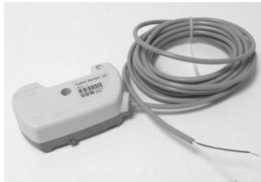
Das im Zählwerk integrierte Target dreht sich proportional zum gemessenen Volumen. Die Position der Metallfläche auf dem Target wird von drei im Cyble-Encoder-Modul integrierten Spulen rückwirkungsfrei abgetastet. Je nach Position des Targets wird die unterschiedliche Dämpfung des Schwingkreises im Cyble-Encoder gemessen. Pro voller Umdrehung wird der Zählerstand hochgezählt.
